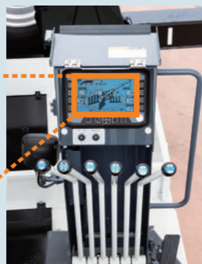
負荷率、旋回角度、起伏角度など様々な車両情報を確認できるマルチモニター
