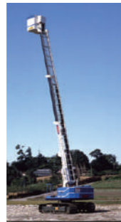
1981年 (昭和 56年) SP180 型 自走式高所作業車 船舶の建造や修繕作業から足場をなくして 効率化する「無足場工法」の実現に向けて 足場のかわりとなる自走式高所作業車を 開発しました
