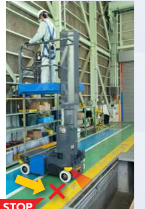
危険な段差を検知した際に車両を自動停止します。
