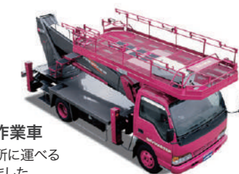
1997年 (平成 9年) SH106 型 高所作業車 電気・通信工事業用に 作業範囲を拡大した 高所作業車を開発 しました
