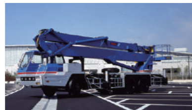
1987年 (昭和 62年) SC400 型 直屈伸型大型高所作業車 最大高さが40mに届く、大型の高所作業車を 開発しました
