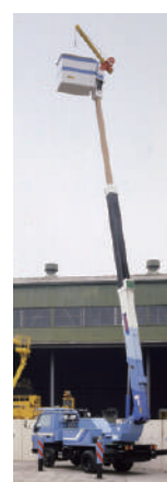
1985年 (昭和 60年) SN130 型 配電工 多関節型高所作業車 無昇柱での配電工事の実現に向けて 多関節型高所作業車を開発しました
