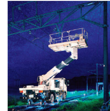
ジャッキ未接地の状態でも 従来機プラス1.2mの作業範囲を実現
