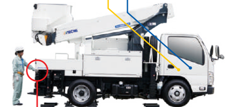
インターロックが作動し、ジャッキ操作を規制
