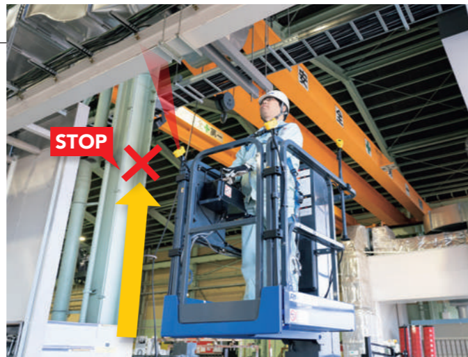
センサーが障害物を検知すると、機械作動を減速または停止します。
