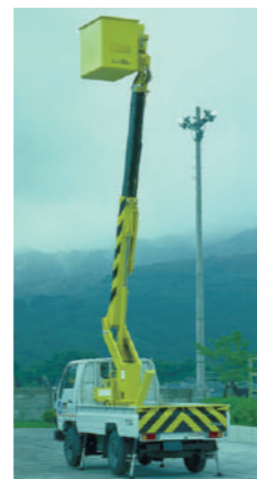
1986年 (昭和 61年) SH080 型 高所作業車 通信工事業界で、高所作業車の 導入が進みました
