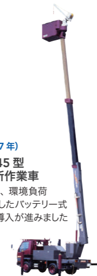
1996年 (平成 8年) SH105EV 型 高所作業車【試作車】 静穏に作業ができ、CO 2 排出もない 環境にやさしい全電動型 (バッテリー駆動) 車両を開発しました
