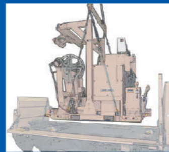
着脱式架線装置(兼用機): 全ての装置を1ブロックとして台座に搭載。 クレーンやフォークリフトで簡単に着脱可能です
