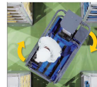
スピントーン機能により狭いスペースでも旋回操作が可能
