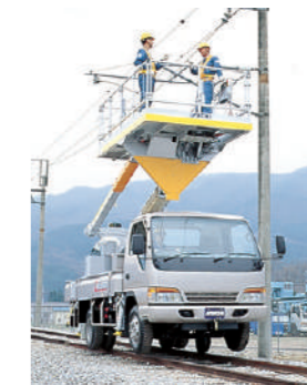
1997年 (平成 9年) RL050 型 軌陸両用高所作業車 夜間の限られた時間内に作業を 行う鉄道工事業用の高所作業車を 開発しました
