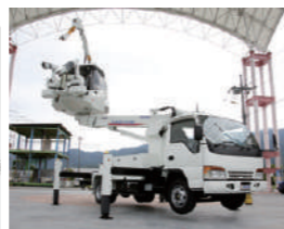
1989年 (平成元年) マニピュレーター 無昇柱で配電工事のすべてが できる次世代型高所作業アーム であるマニピュレーターを 先駆的に開発。その使用効果を 確認しました
