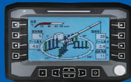
さまざまな情報を操作席の液晶画面に表示する「マルチモニター」
