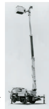
1985年 (昭和 60年) SN130 型 配電工 多関節型高所作業車 無昇柱での配電工事の実現に向けて 多関節型高所作業車を開発しました
