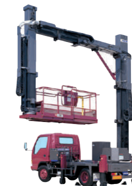
1998年 (平成 10年) SF44A 型 橋梁点検車 高架道路の防音壁や、橋梁での 作業に対応した橋梁点検車を 開発しました
