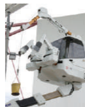
1985年 (昭和 60年) RV040 型 小型自走式高所作業車 大規模建造物の内装工事での「無足場 工法」の実現に向けて、クローラ タイプの小型自走式高所作業車を開発しました
