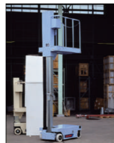
1987年 (昭和 62年) SV030 型 小型自走式高所作業車 大規模建造物の内装工事での 「無足場工法」の実現に向けて ホイールタイプの小型自走式 高所作業車を開発しました
