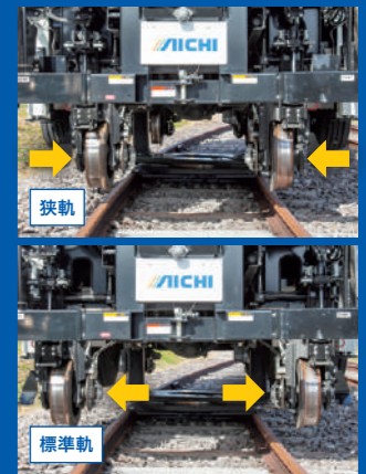
現場の線路に合わせて、鉄輪幅を油圧動力で切替することができる「狭標両用機構」
