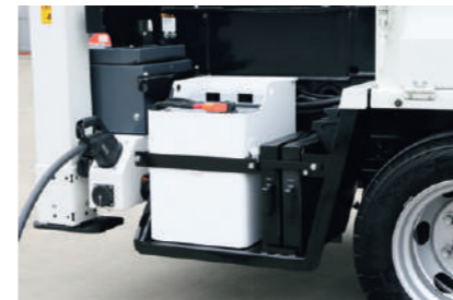
エネルギー密度が高く、コンパクトな「リチウムイオンバッテリー」 ※撮影用にカバーを外しています
