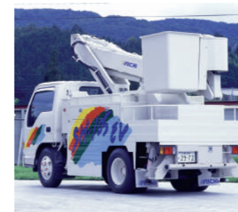
1996年 (平成 8年) SH105EV 型 高所作業車【試作車】 静穏に作業ができ、CO 2 排出もない 環境にやさしい全電動型 (バッテリー駆動) 車両を開発しました
