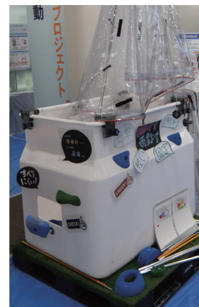
好評だったボルダリングホールドを設置して、乗降がしやすくなったバケット
