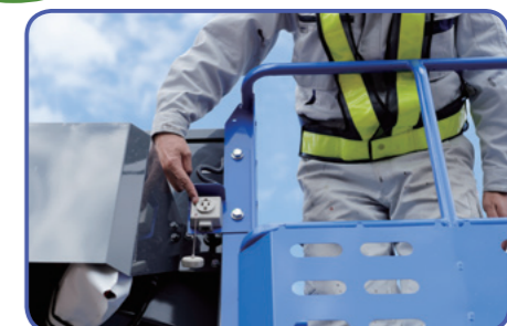
バスケットに100Vの電源取出口を装備 ※使用の際、下部で発電機との接続が必要です
