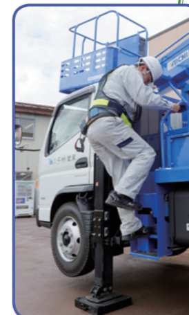
車両前方に乗降ステップと手摺りを配置
