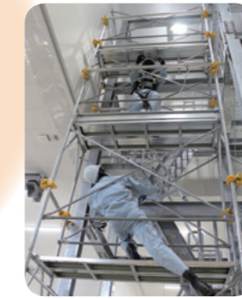
枠組み足場に設置された不安全体勢の人形を見てリスクを体感する足場からの墜落体感設備
