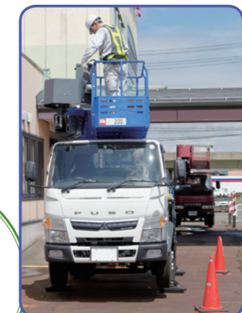
直下型ジャッキ(手前)は車両占有幅が小さく、幅が限られた場所でも設置可能
