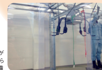
6600Vの電気設備がショートする状況が見られる高圧感電体感設備
