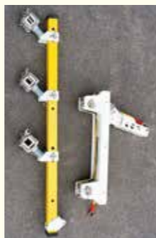
四面ローラーと仮腕木、スライド起伏ヘッド。軽くて丈夫、電気が流れにくい素材を採用
