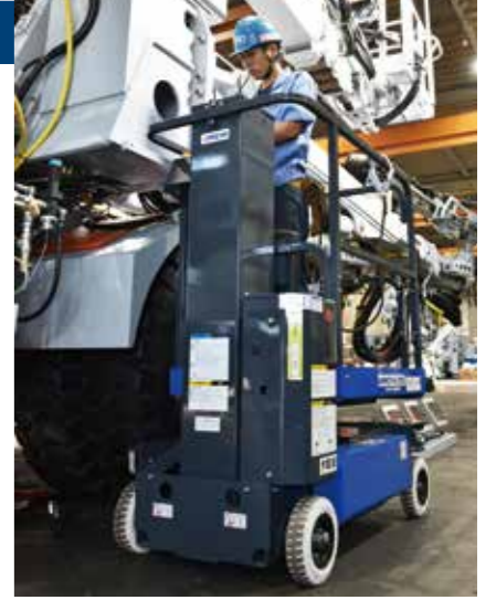
微速動作により、作業位置を決めやすい点もメリットのひとつ
