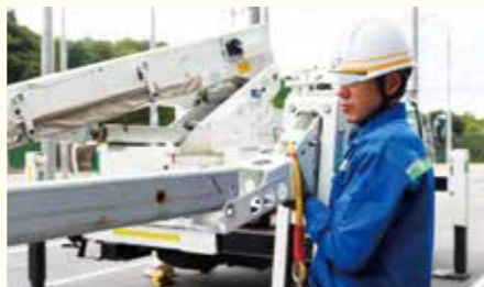
1人で持つことができる総重量20kg以下を実現。作業効率上がる
