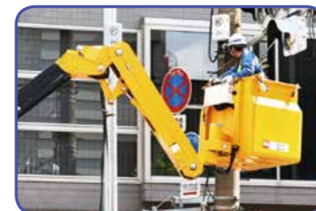
先端屈折アームを下に曲げて信号機をかわし、反対側へと移動
