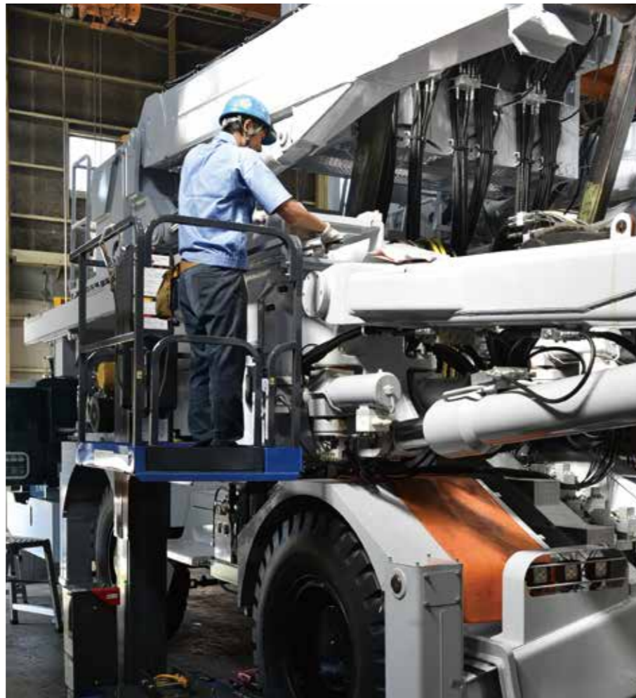
大型機械ではボルトの締め付けトルクも大きくなるため、安定した作業環境が求められる
