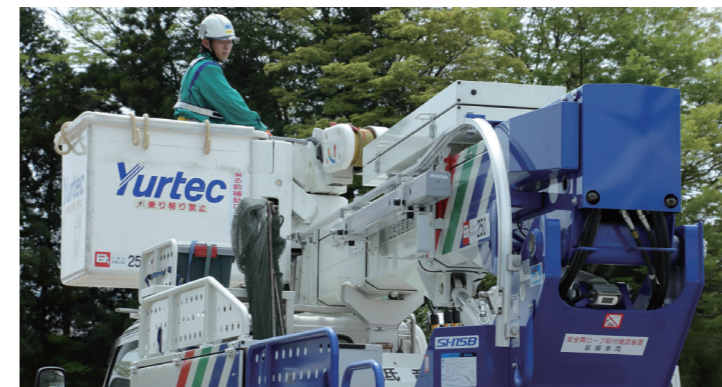
高所作業車からの転落を防止する「アシストレール」。バケットへの乗り込みまでを、SH15Bを使って実際に行っていたいた。
