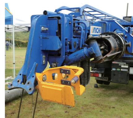
穴掘建柱車ブーム先端への取り付け状態。両サイドに取り付けできる
