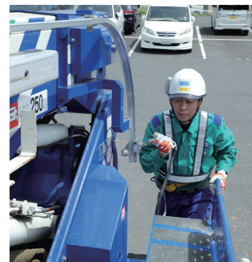
安全器は、上側（バケット側）に倒すとフリーになり可動で、下側（地上側）に倒すとブレーキがかかる。
