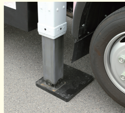
ジャッキを降ろすだけで設置が完了、重いジャッキベースを設置する手間が省ける
