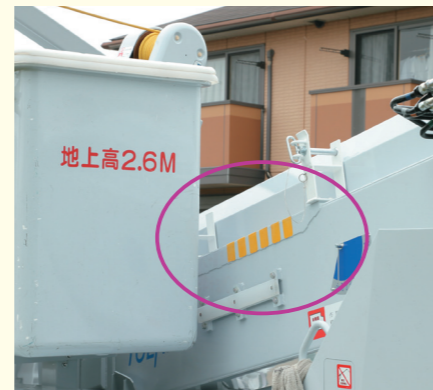
靴底が濡れていても滑らず、安心してバケットに乗降できる
