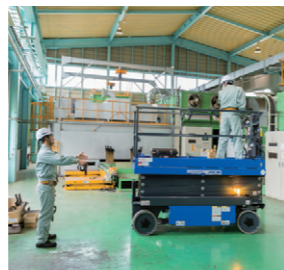
走行・昇降警報装置の音とストロボライトにより、周囲にも注意喚起を行う
