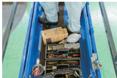
最大積載荷重250kg。作業員2名と工具箱、交換部品を載せられる
