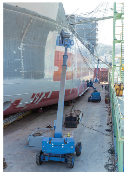
SP25CSMは最大地上高25m。大型船上部の塗装にも十分対応できる
