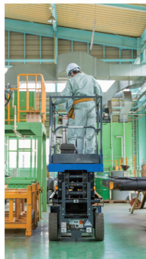
幅81cmのスリムなボディ。小回りが利くので狭い通路にも楽に進入できる
