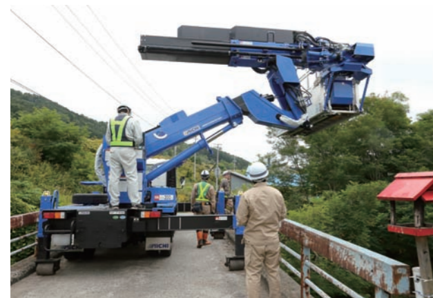
車両の右側でも作業可能なので、現場の状況に合わせて対応がしやすい
