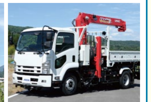
新幹線の耐震工事でビームを搬送したクレーン車 UJ083型軌陸両用自積載クレーン車
