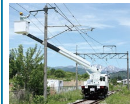
操作性の良い最大地上高17mの高所作業車 軌陸両用高所作業車 LK17KFE
