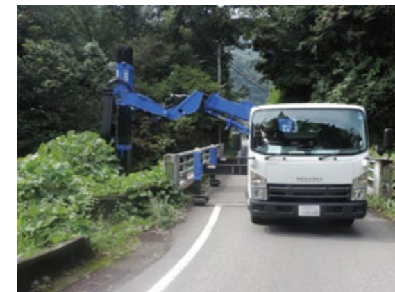
車両の右側でも作業可能なので現場の状況に合わせて対応がしやすい
