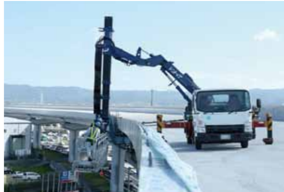
排水管の設置作業を余裕でこなすSF77AⅢ。さらには、作業床を伸ばして橋脚下の奥まで作業範囲が広がられる
