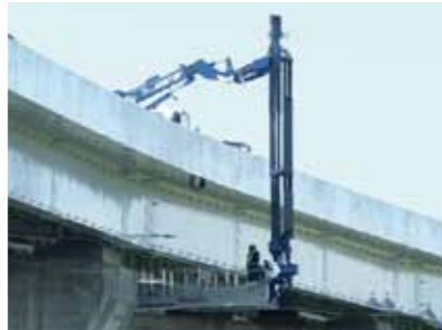
排水管の設置作業を余裕でこなすSF77AⅢ。さらには、作業床を伸ばして橋脚下の奥まで作業範囲が広がられる
