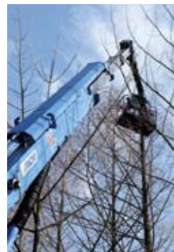
先端屈折式により、周囲の樹木を傷めずに作業できることがよく分かる
