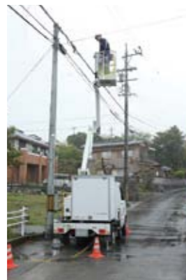
作業床最大地上高を5.4mとするSC05A。安定性も高い
