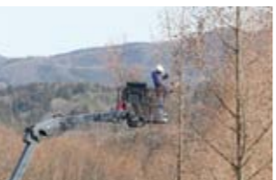
先端屈折式により、周囲の樹木を傷めずに作業できることがよく分かる
