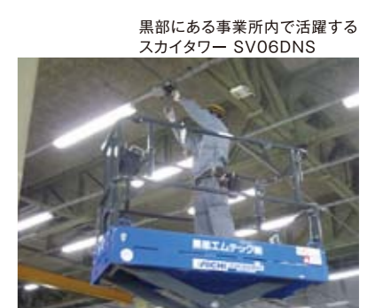
黒部にある事業所内で活躍するスカイタワー SV06DNS 操作性を高めた「プロポーションステアリング」
