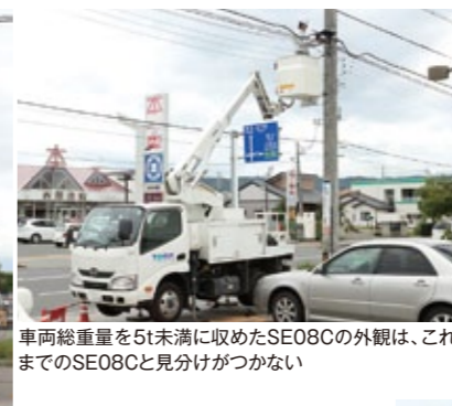
全体の積載量は少なくなったが、最低限の機材の積載と6.5m梯子などを積めるスペースは5t未満仕様車でも確保されている(写真は従来のSE08C)
