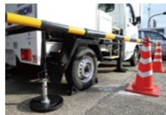
ジャッキは車体中央にある油圧式(左右2本)。細路地の駐車に楽にするようジャッキの張り出し幅を最小に抑えている。なお、手前にはスタンド(手動)だ
