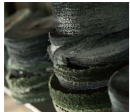
研磨に使うバフは、何枚もの布を張り合わせて作る。仕上がりの出来を左右する、磨き屋にとって大事な商売道具
