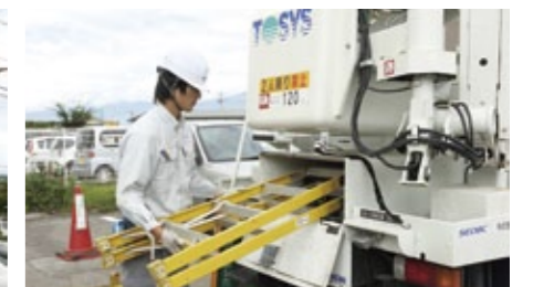
全体の積載量は少なくなったが、最低限の機材の積載と6.5m梯子などを積めるスペースは5t未満仕様車でも確保されている(写真は従来のSE08C)
