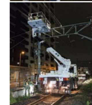
“大ゴクウ”の愛称通り、自由度が高い作業床の作業半径がこれまでのU565(小ゴクウ)よりさらに広がった
