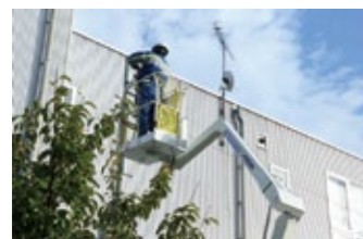
最大地上高付近で大きな作業半径を持たせるため、ブームは屈折式だ
