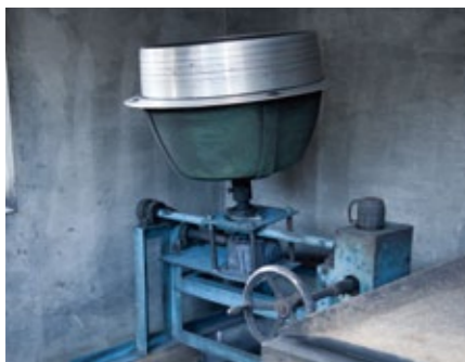
この「星掛け器」の中で何回にも分けて芯に薬品を塗り、育てるように「星」をゆっくりと作っていく
