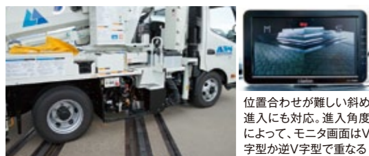
ダッシュボードに搭載された新システムと運転席右側に設定されている画面モニタ。車の速度とモニタ画面の変化のスピードが程良く同調しているため、経験の少ない運転手でも短時間での載線が可能だ
