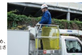
屈折式ブームで広い作業可能領域が確保でき、最大地上高は5.4m
