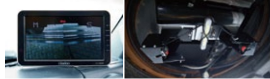
転車台裏の両端に取り付けられた2台のCCDカメラで、レールとの位置関係を検知。画面上のレールが重なれば、そこが停止位置だ
