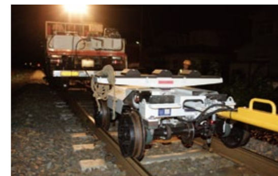
軌陸車(UJ092)に連結されたブレーキ連動トロ。従来のトロとはまったく違う機能を持ち、形状も異なる。このトロはいわば電柱搬送仕様だ
