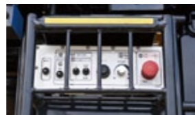
わざわざ運転席に上がらずとも軌陸車を動かすことができる「微速走行操作装置」
