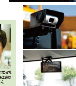
お客さまの安心・安全を考え、西尾レントオール様ではカーナビに加え、バックモニターカメラを独自の位置に取り付け、また、視認性を高めた巻き込み防止バーも取り付けている
