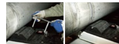
載せた電柱を安定させる歯止めにも工夫が凝らされている
