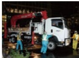
U650の軌道への搬入。転車台で車体を持ち上げ、作業員が車体を回転させて線路に乗せる
