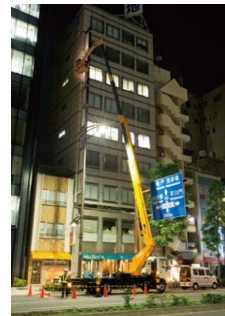
8t限定中型免許で運転可能な高所作業車では、最長を誇るSJ30ARS
