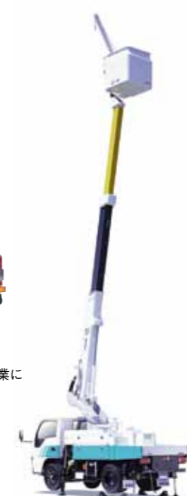
SH106型 高所作業車 1997(平成9)年 電気・通信工用向けに、作業範囲を拡大した高所作業車を開発しました
