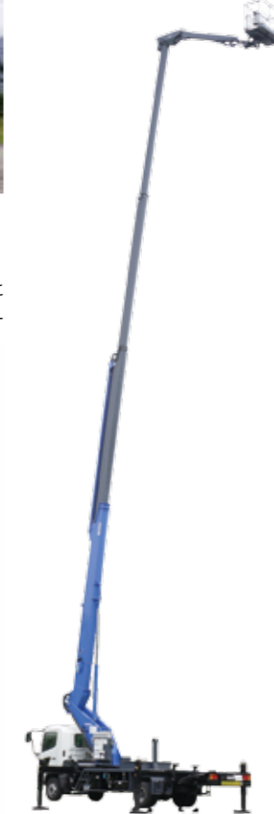
SJ30ARS型 先端屈折型高所作業車 2012(平成24)年 「限定中型免許で運転できる車両で、 より高い場所での作業を行いたい」と いうニーズに対応した、30m級高所 作業車を開発しました
