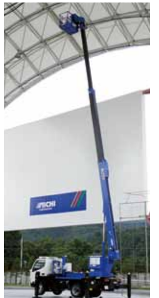
SK17A型 高所作業車 バッテリー仕様車【参考出品】 2012(平成24)年 建設・設備メンテナンス工事向けパ ッテリー仕様車を開発しました
