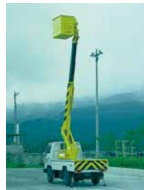
SH080型 高所作業車 1986(昭和61)年 通信工事業界で、高所作業車の導入が進みました
