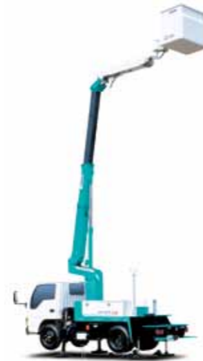
SE10A型 先端屈折型高所作業車 2002(平成14)年 長いスパンでの連続作業や「障 害物をかわして作業を行いたい」と いうニーズに対応した、高所作業車 SEシリーズを開発しました
