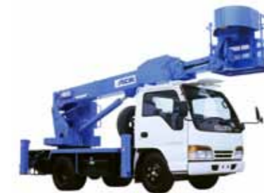
SJ126型 先端屈折型高所作業車 1996(平成8)年 建設・設備メンテナンス工事業界で、高所作業車の導入が進みました
