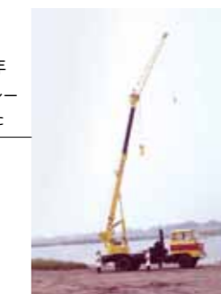
ACD4E型 穴掘建柱車 1966(昭和41)年 「建てる」「掘る」を一体化した穴掘建柱車を開発しました
