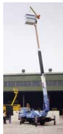
SH138型 配電工用高所作業車 1984(昭和59)年 配電工事業界で、高所作業車の導入が進みました
