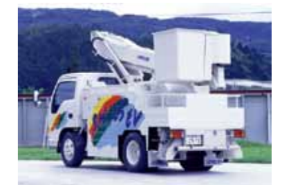
SH105EV型 高所作業車【試作車】 1996(平成8)年 静穏に作業ができ、CO2排出もない環境にやさしい全電動型(バッテリー駆動)車両を開発しました
