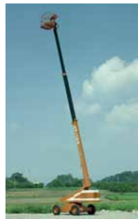
SP180型 自走式高所作業車 1981(昭和56)年 船舶の建造や修繕作業から足場を無くして効率化する「無足場工法」実現に向けて、足場のかわりとなる自走式高所作業車を開発しました
