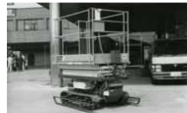
RV040型 小型自走式高所作業車 1985(昭和60)年 大規模建造物の内装工事での「無足場工法」実現に向けて、クローラタイプの小型自走式高所作業車を開発しました
