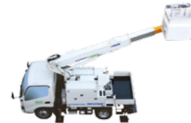
SH11A型 高所作業車 バッテリー仕様車 2008(平成20)年 通信工事業界でも、バッテ リー式低騒音ユニットの導 入が進みました
