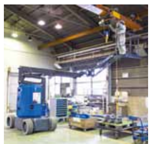
WU09A型 アップ&オーバー型 自走式高所作業車 2011(平成23)年 工場設備メンテナンス工事向けに「障 害物をかわして作業を行いたい」とい うニーズに対応した、自走式高所作業車 を開発しました
