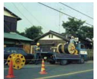
K200型 ケーブル車 1970(昭和45)年 ケーブルの繰り出し作業に対応したケーブル車を開発しました
