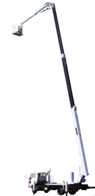
SJ240型 先端屈折型高所作業車 1990(平成2)年 複雑な設備に対応する、建設・設備メンテナンス工用高所作業車を開発しました
