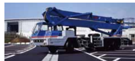
SC400型 直屈伸型大型高所作業車 1987(昭和62)年 最大高さが40mに届く、大型の高所作業車を開発しました
