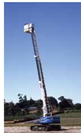
SR120型 自走式高所作業車 1983(昭和58)年 地盤の悪い建設現場での「無足場工法」実現に向けて、クローラタイプの自走式高所作業車を開発しました
