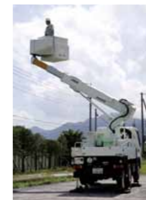
SH10A型 高所作業車 走行充電式バッテリー仕様車 2010(平成22)年 電気・通信工事向けに、走行時に 充電ができるバッテリー式低騒音ユ ニットを開発しました
