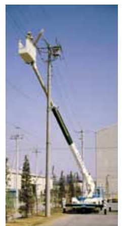
SH135型 配電工用高所作業車 1976(昭和51)年 活線作業装置としての絶縁性能を確保した配電工用高所作業車を開発しました
