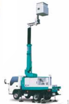
SE08A型 先端屈折型高所作業車 2008(平成20)年 通信工事向けに「障害物をかわして 作業を行いたい」というニーズに対 応した、高所作業車を開発しました
