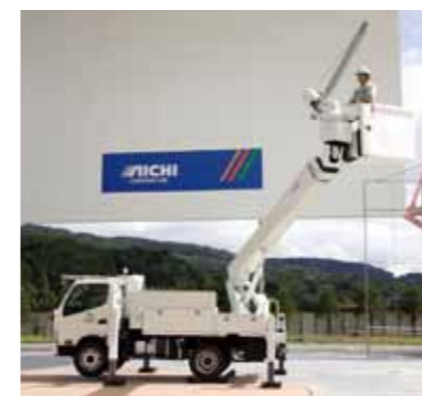
SH15B型 配電工事用高所作業車 2004(平成16)年 配電工事業界では、導入される高所作業車の8 割がバッテリー式低騒音ユニット付きとなりました
