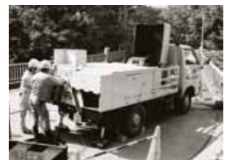
K200型 ケーブル車 1970(昭和45)年 ケーブルの繰り出し作業に対応したケーブル車を開発しました
