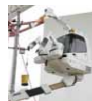
SC400型 直屈伸型大型高所作業車 1987(昭和62)年 最大高さが40mに届く、大型の高所作業車を開発しました
