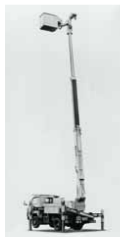
SN130型 配電工用多関節型高所作業車 1985(昭和60)年 無昇柱での配電工事の実現に向けて、多関節型高所作業車を開発しました
