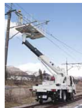
SE10A型 先端屈折型高所作業車 2002(平成14)年 長いスパンでの連続作業や「障 害物をかわして作業を行いたい」と いうニーズに対応した、高所作業車 SEシリーズを開発しました
