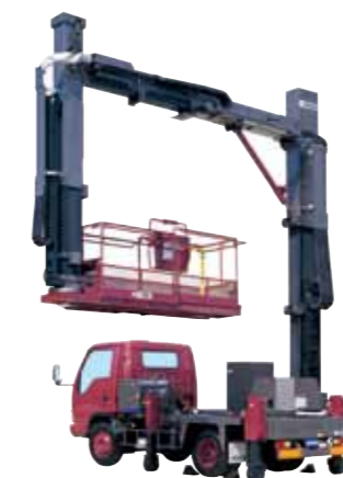
SF44A型 橋梁点検車 1998(平成10)年 高架道路の防音壁や、橋梁での作業に対応した、橋梁点検車を開発しました
