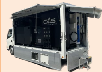
発電・蓄電・給電が可能な多目的電源車
