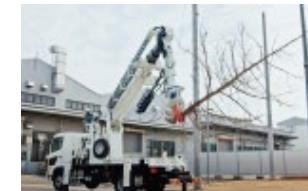
架空線へのかかり木や倒木の除去に対応できる作業車
