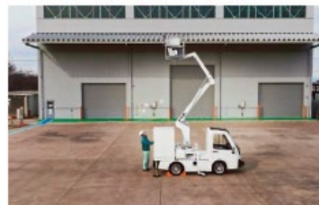
EV高所作業車
